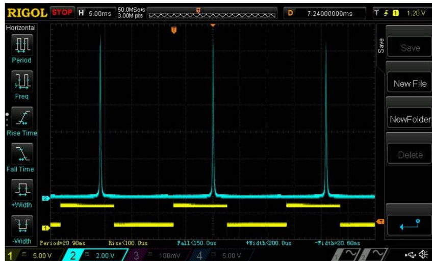
Mesure de largeur de raie à l'aide de l'interféromètre Fabry-Perrot
